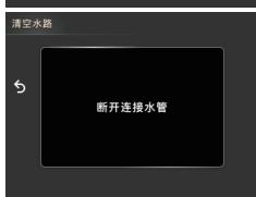
屏幕提示“清空水路”，确认。根据提示，断开水管或取出水箱，确认，咖啡机开始自动清理水路。清空水路完成后，咖啡机会自动关闭总电源。电源关闭后取出蓄水盘，将蓄水盘内的水清理干净
