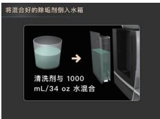
取下水箱，并将混合好的除垢液体加入水箱
