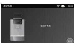
屏幕提示“清空水路”，根据提示，断开水管或取出水箱，确认，咖啡机开始自动清理水路。清空水路完成后，咖啡机会自动关闭总电源。电源关闭后取出蓄水盘，将蓄水盘内的水清理干净
